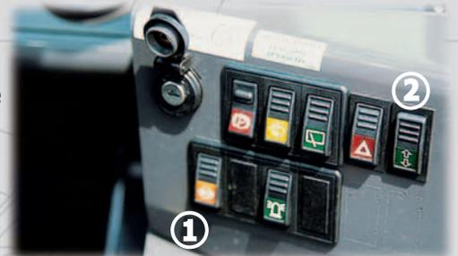
② - Il sollevamento elettro-idraulico del posto guida (standard), consente un facile accesso al motore per le operazioni di manutenzione riducendo i tempi di intervento.
